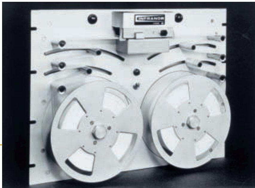
Fotoelektrischer Lochstreifenleser Typ SP, mit Sonderausführungen für Lochstreifen mit 13 und 16 Kanälen, für Olivetti-Band und Lesekopf für ECMA-Code und TTS.
